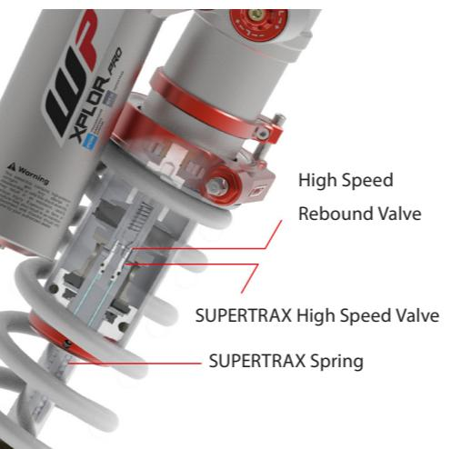
Separate adjustment of high-speed and low-speed compression damping to adapt the damping performance perfectly and flexibly to the rider's needs. // Réglage séparé de l'amortissement de compression haute et basse vitesse pour adapter parfaitement et de manière flexible les performances d'amortissement aux besoins du pilote
